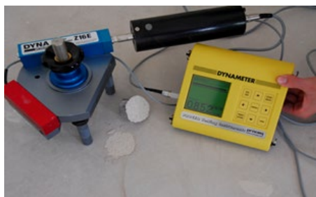
Haftzugprüfung mit Bruchbild und Stempel
